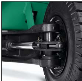
Dirección hidrostática que elimina las sacudidas
