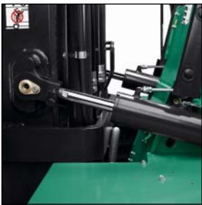
Cilindros de inclinación con casquillos esféricos
