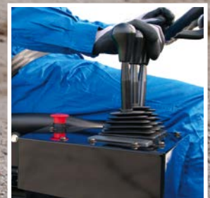
Palancas ergonómicas mecánicamente aisladas que reducen la vibración
