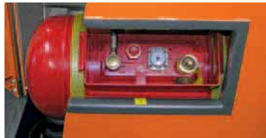
Depósito de gas
