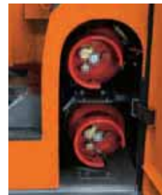
Bombonas de gas reemplazables
